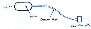
شکل ۴-۶ مخزن مایع و روش اندازه‌گیری سنسور فشار برای تشخیص دما. حجم مایع در لوله موئین بایستی در مقایسه با مایع داخل مخزن قابل صرف نظر کردن باشد.
